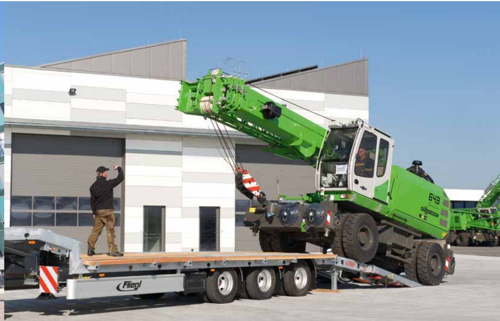
643 M - quick to transport by simple self-loading using a ramp 643 M - schnell transportfähig über einfache Selbstverladung über Rampe
