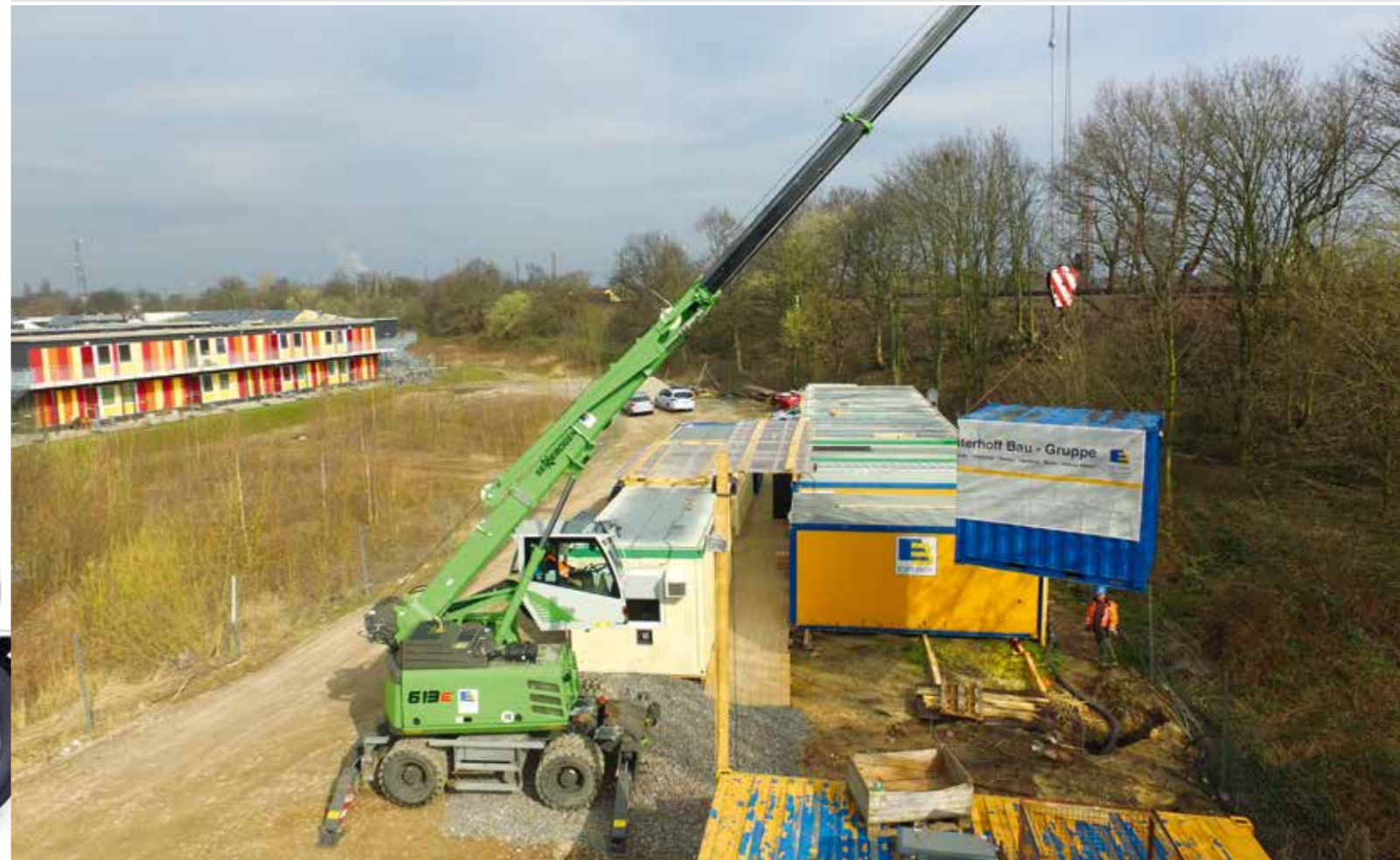
613 M - flexible 16 t construction site crane with overview due to elevating cab; Germany 613 M - flexibler 16 t Baustellenkran mit Übersicht dank hochfahrbarer Kabine; Deutschland
