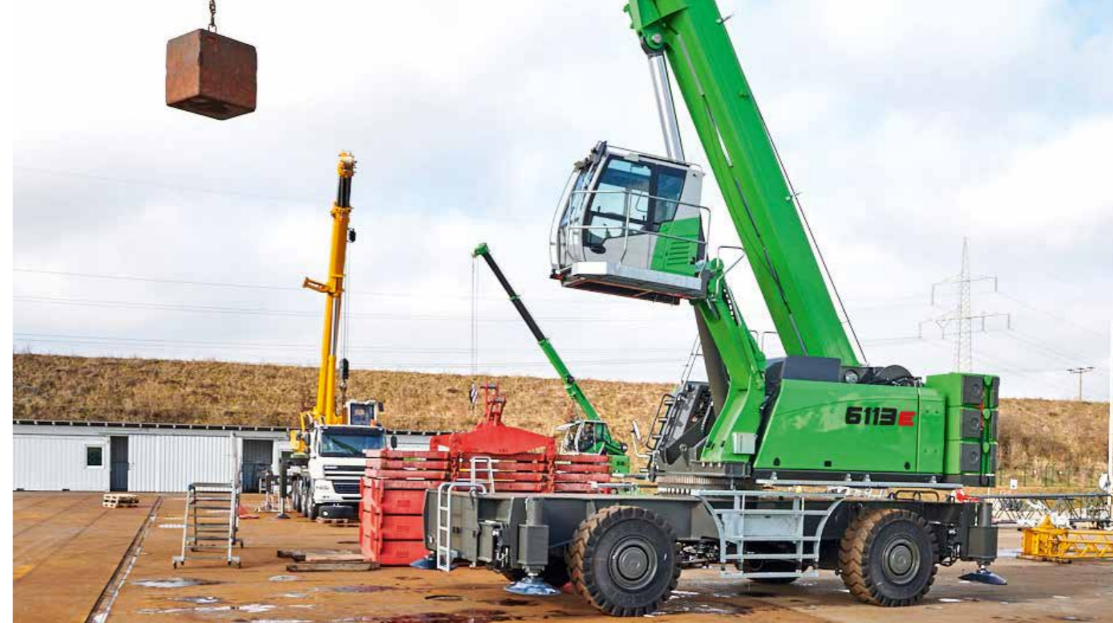
6113 M - elevating cab up to an eye level of 5.70 m 6113 M - PHochfahrbare Kabine auf eine Sichthöhe von 5.70 m
