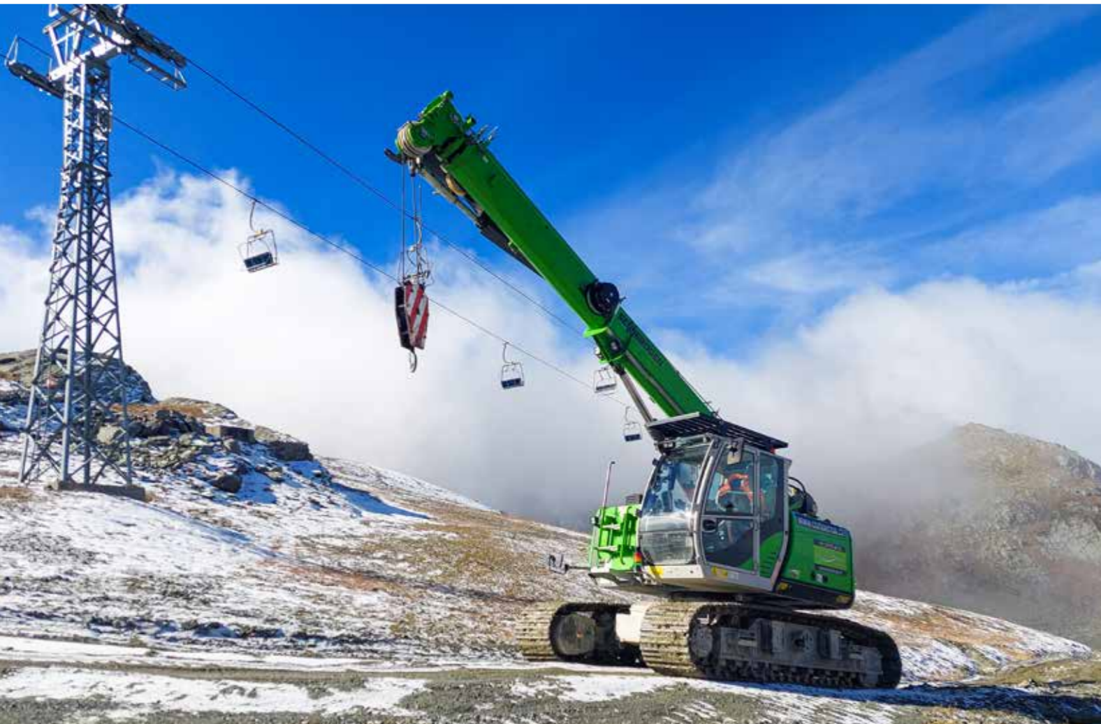
613 R - operation in alpine terrain: climbing a mountain with its own travel drive; Switzerland 613 R - Einsatz in alpinem Gelände: Hochfahren eines Berges mit dem eigenen Fahrtrieb; Schweiz
