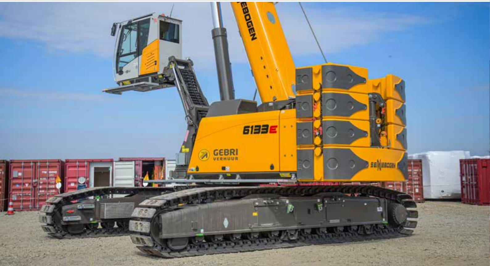
6133 - available with elevating cab as option; Netherlands 6133 - Optional mit hochfahrbarer Kabine erhältlich; Niederlande
