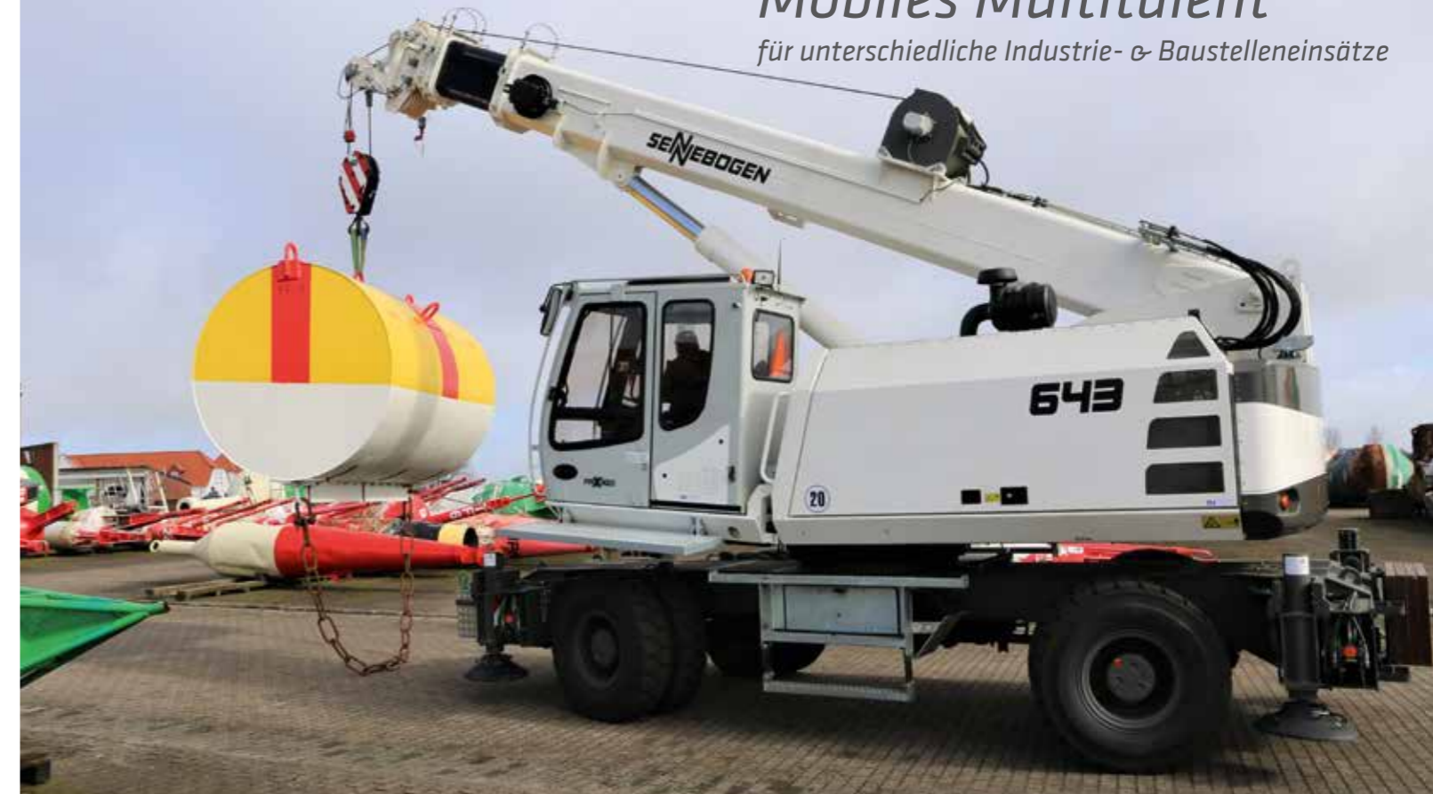
643 M - Pick & Carry with seawater branding of the Waterway Authority; Germany 643 M - Pick & Carry mit Seewasserzeichen des Wasserschiffahrtsamtes; Deutschland
